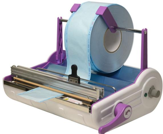
Упаковочная машинка Selin – компактная термосварочная машинка для упаковки различного медицинского инструмента перед стерилизацией и последующего хранения.
