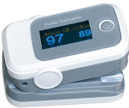
Упрощенный портативный пульсоксиметр для использования в домашних условиях, стационаре, при оказании первой помощи. На цветном LED дисплее отображается цифровая информация о насыщении крови кислородом и частоте пульса.
