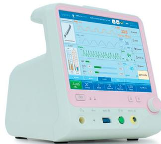
Аппарат ИВЛ S1500A – пневматический электрический аппарат для дыхательной поддержки детей и новорожденных, в том числе недоношенных. Может использоваться как в портативном варианте, так и в мобильном варианте на тележке с колесами.
