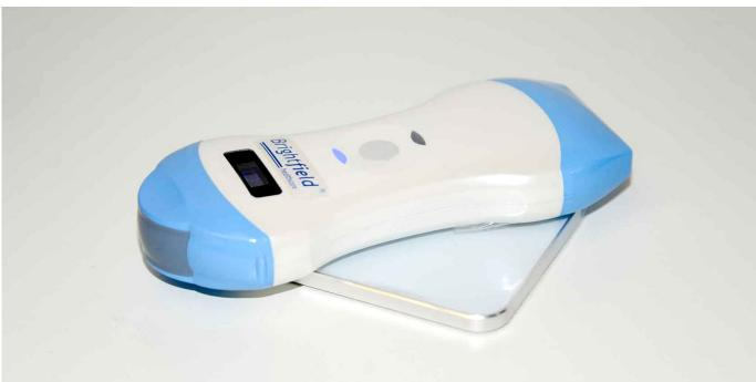
Например, при проведении интервенционных процедур ультразвуковой WiFi-датчик решает проблему стерильности, а также отпадает необходимость в ассистенте, который настраивает изображение. Ультразвуковой контроль становится более эффективным - место манипуляции и экран можно расположить в одном направлении.
