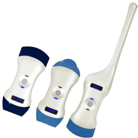
Ультразвуковые датчики UProbe-C5 – линейка беспроводных ультразвуковых датчиков с двумя сканирующими головками (линейные, конвексные и микроконвексные решетки).
