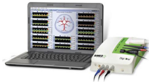
Digi-One - портативная цифровая система 7 поколения для проведения эхо энцефалографии традиционным одномерным режимом, а также импульсными и постоянноволновыми доплеровскими режимами.
