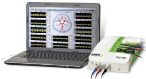
Digi-One - портативная цифровая система 7 поколения для проведения эхоэнцефалографии традиционным одномерным режимом, а также импульсными и постоянноволновыми допплеровскими режимами.
